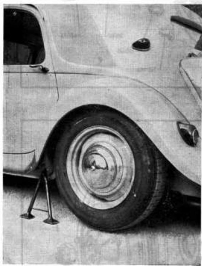
Levage d'une roue arrière à l'aide du bipied spécial
