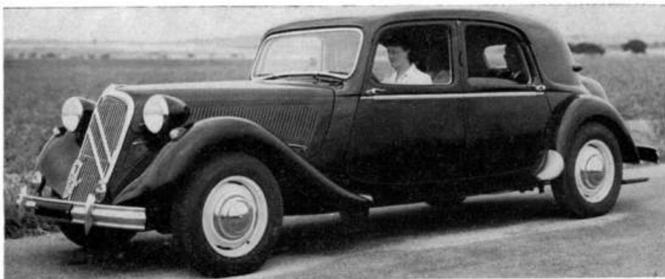
La « 15 » sous sa dernière forme : clignotants et malle arrière. Les pneus 185 x 45 l'identifient comme n'ayant pas encore la suspension hydropneumatique
