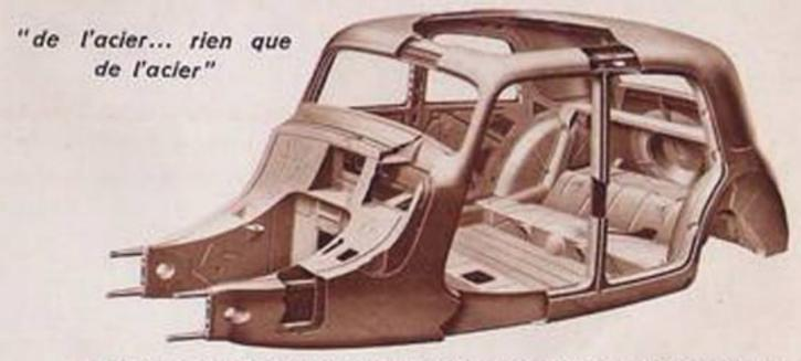
Toutes les Traction-Avant Citroën sont des "Monocoques Tout-Acier". Châssis et carrosserie forment un bloc homogène entièrement métallique, d'une résistance aux chocs à toute épreuve. La solidité de la "Tout-Acier" constitue un véritable bouclier qui protège efficacement les passagers contre les risques de la route.
